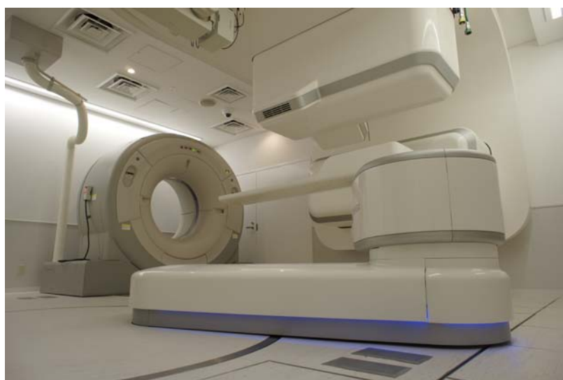
新治療研究棟のシミュレーション室内に設置されている ロボットアームで操作できる治療台の写真
